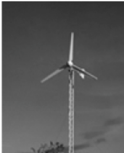
Gráfico 7.12: Microturbina eólica de 3.000 W (Surface Power, 2006)
