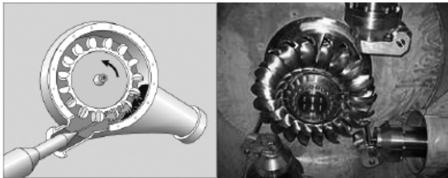
Gráfico 8.4. Turbina Pelton (Departamento de Energía, 2006)
